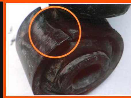
Falta del tope de rebote
