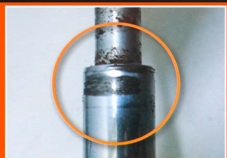
Marcas en el vástago durante la instalación
