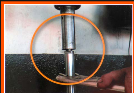
Marcas en el vástago durante la instalación
